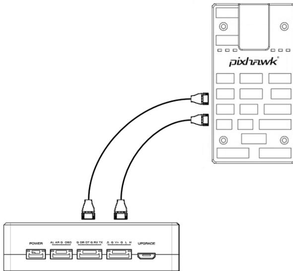
数传连接：6PIN 接口连接天空端模块的串口（UART），另一端连接飞控的数传接口。数传波特率可配置。
