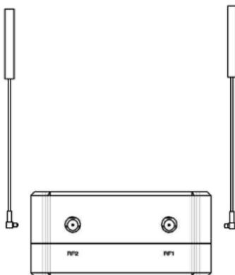
安装天空端天线分别至 RF1 及 RF2 接口。正确安装好时会出现“咔嚓”一下的声音，接口完全装好。
