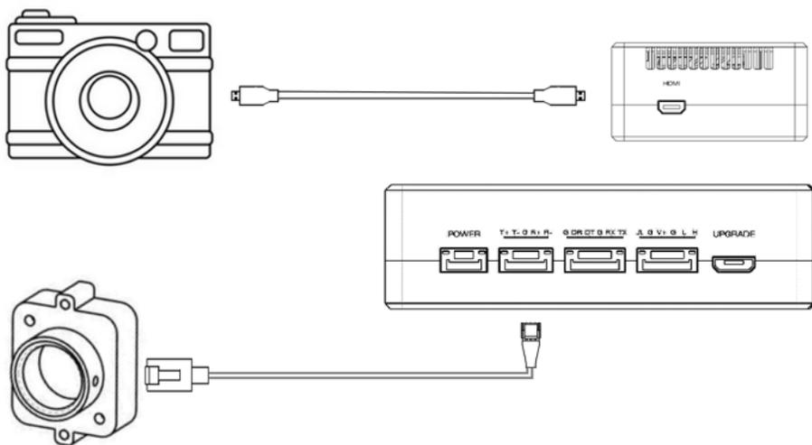
连接相机的 HDMI 视频输出接口至天空端模块的 HDMI 接口。
